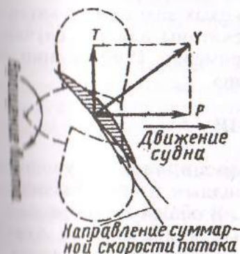
Рис. 19. Схема силы упора гребного винта
